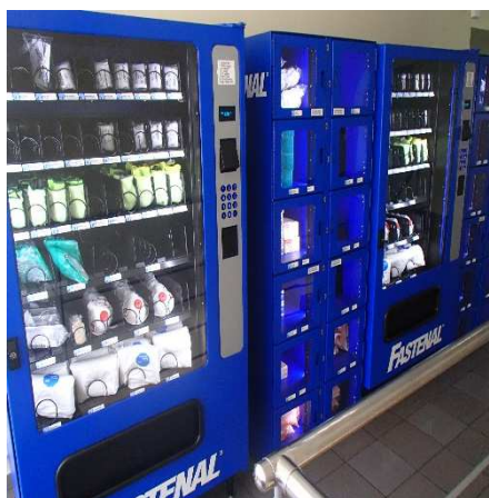
Dystrybutory środków ochrony indywidualnej. Dostęp do wybranych środków jest możliwy dzięki indywidualnym kartom magnetycznym
