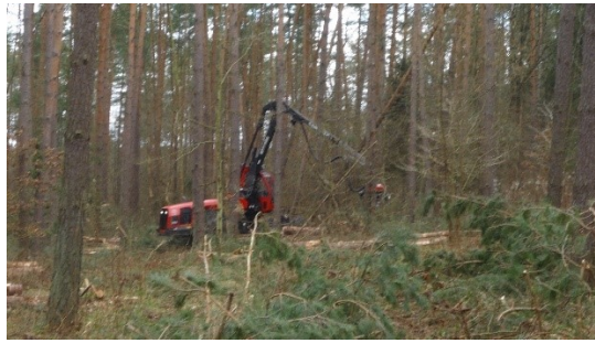
Ścinka drzew wykonywana sprzętem mechanicznym HARWESTER KOMATSU 901 rok prod. 2018 udźwig 3,600 t.
